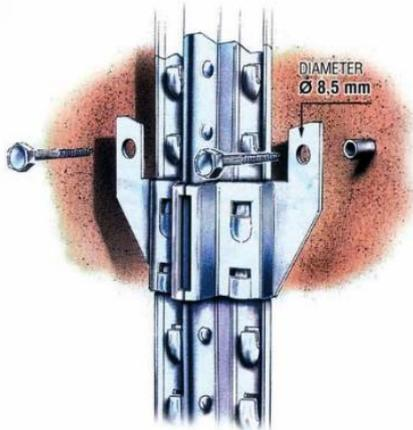
Setzen Sie die Wandhalterung auf die Befestigungslaschen an der Säule.
