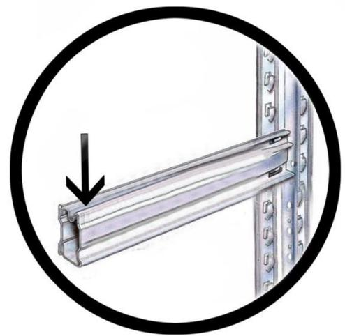
Setzen Sie die Längsträger in der gewünschten Höhe auf die Halterungen an der Pfosten. Der Aufnahmeschlitz für das Regalpaneel am Längsträger muss nach oben zeigen, wie in der Abbildung mit dem Pfeil dargestellt.
