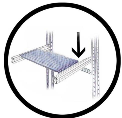
Setzen Sie die Regalpaneels in die Aufnahmeschlitzte am Längsträger.
