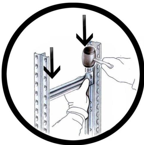
Legen Sie den Querverbinder (wie in der Abbildung gezeigt) auf die Verbindungsöse am Rücken eines der Säulen und schlagen Sie die beiden Seiten des Verbinders abwechselnd an die Pfeilmarkierungen.
