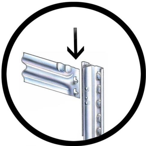
Stecken Sie die erste schräge Diagonalverbinder zwischen die beiden Säulen und schlagen Sie ihn dann vorsichtig mit dem Gummihammer ein, abwechselnd erst auf die eine und dann auf die andere Seite. Klopfen Sie mit dem Gummihammer die schräge Diagonalverbinder auf das verstärkte Teil.
